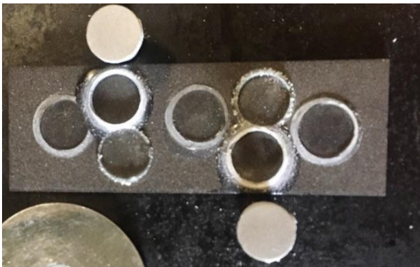
Gambar 4. 14 Tampak atas hasil uji pull off
