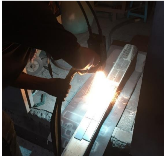
Gambar 3.13 Proses thermal arc spray
