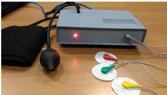
**Gambar B.1** *Prototype* tensimeter dan elektrokardiograf
