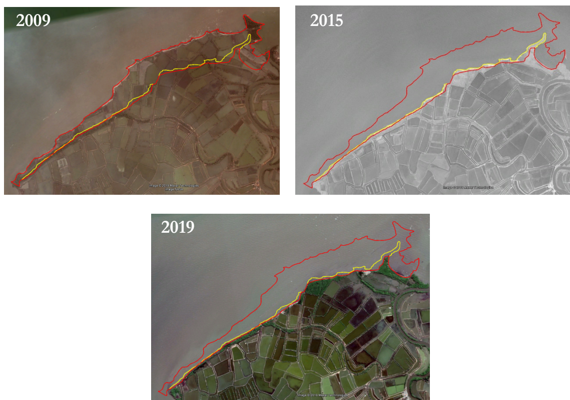
Gambar 4. Hilangnya daratan seluas 52,41 ha di Desa Susukan Kabupaten Serang.
