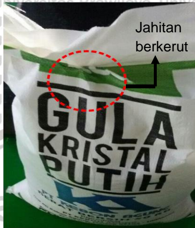
Gambar 4.3 Jahitan Kemasan Rusak Sumber: PG Kebon Agung (2017)
