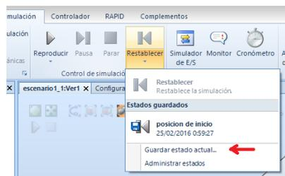
Ilustración 27 Pestaña guardado del estado de la estación
