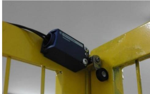
Ilustración 5 Sensor de apertura de puerta
