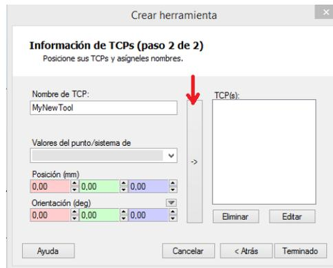
Ilustración 33 Ventana creación TCP Herramienta simulada
