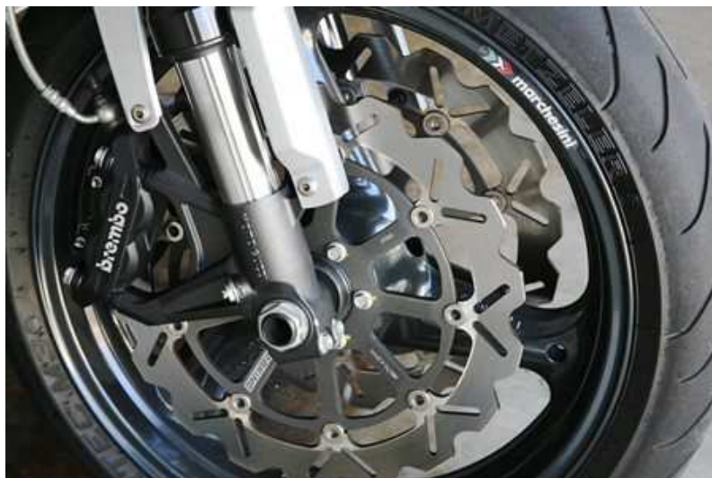
Figura 1. Motocicleta equipada con frenos de doble disco en la rueda delantera.
