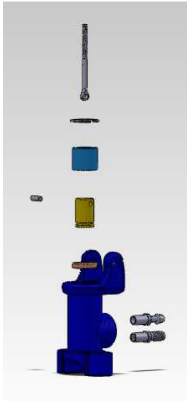
Figura 26. Componentes del cuerpo de la bomba de freno.
