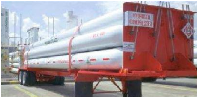
Figura 3.27 Remolque de transporte de cilindros de hidrógeno almacenado como gas comprimido
