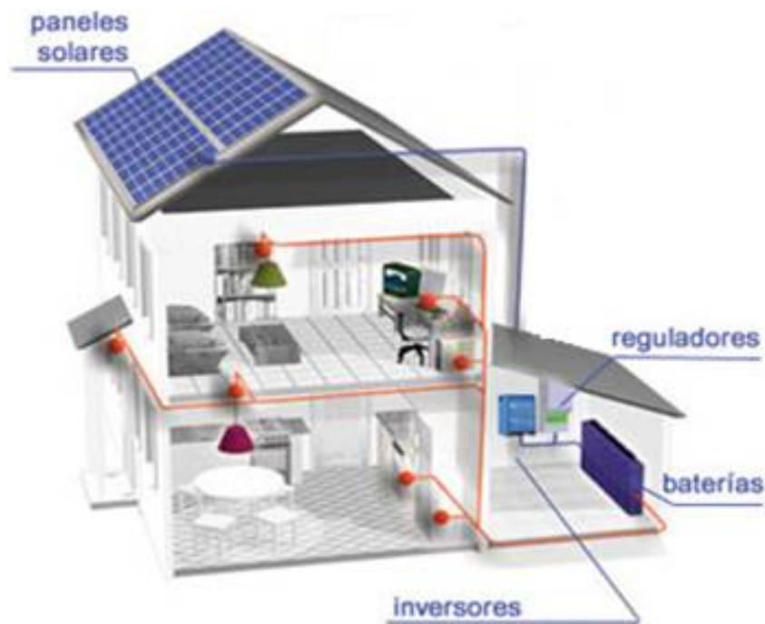
Figura 2.23 Instalación solar fotovoltaica aislada
