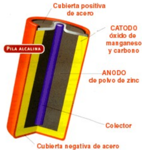
Figura 6.4 Esquema general de una pila alcalina
