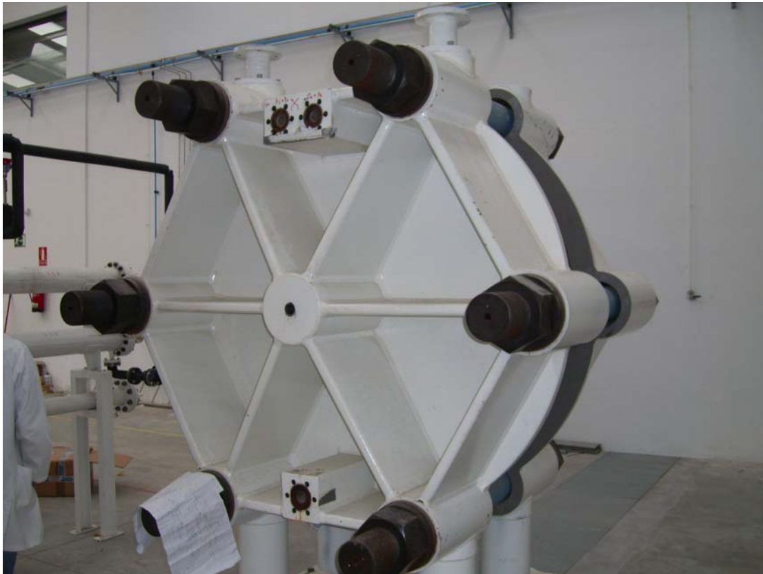
Figura 2.11 Electrolizador de 5kW instalado en el Parque Tecnológico Walqa
