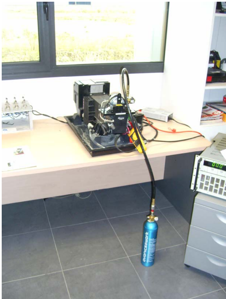
Figura 4.11 Pila de combustible Snack Ballard de 1,2 kW de potencia, producida en serie (Parque Tecnológico Walqa)
