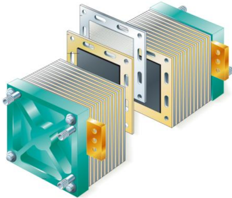
Figura 4.10 Stack de celdas de combustible
