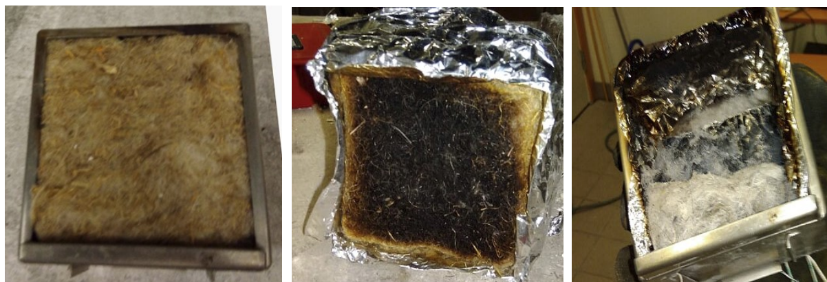
Figur 9. Linullisolering innan exponering, efter försöket med 10 kW/m 2 värmestrålning och efter försöket med 20 kW/m 2
