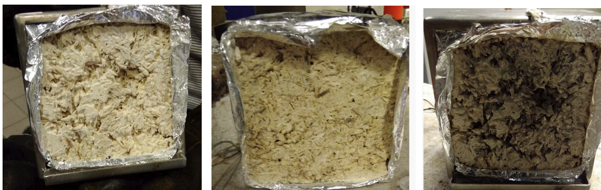
Figur 7. Hampakalken innan exponering, efter försök med 10 kW/m 2 och efter försök med 20 kW/m 2 värmestrålning
