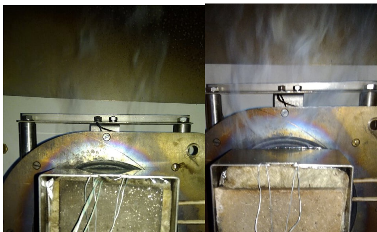
Figur 10. Rökbildning vid försöken med träfiberisolering, där 10 kW/m 2 visas till vänster och 20 kW/m 2 till höger
