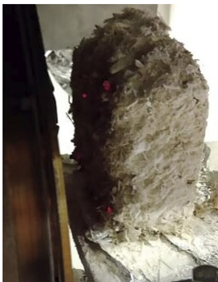
Figur 8. Hampakalk där yttersta kalkskiktet tagits bort och sedan utsatt för 20 kW/m 2 värmestrålning
