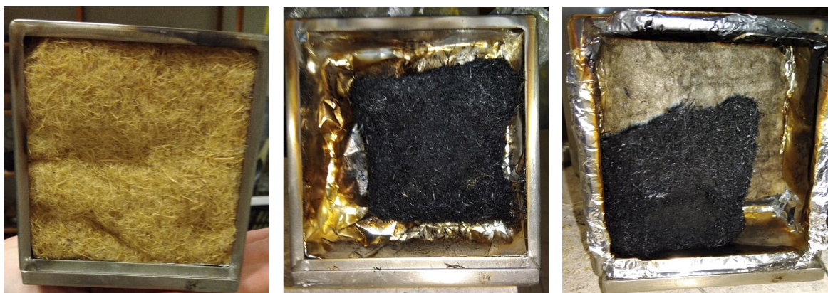
Figur 11. Träfiberisolering innan exponering, efter försök med 10 kW/m 2 värmestrålning och efter försöket med 20 kW/m 2
