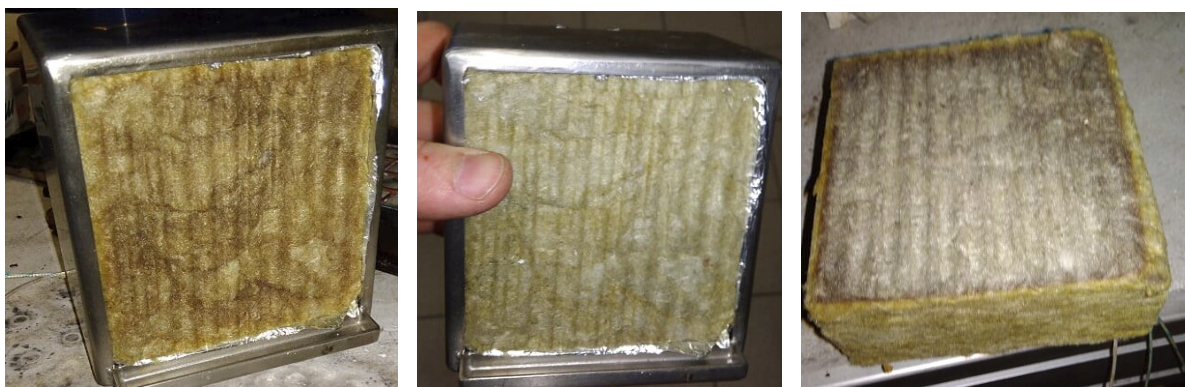
Figur 4. Stenullsisolering innan värmestrålning, efter försök med 10 \text{ kW/m}^2 och efter försök med 20 \text{ kW/m}^2
