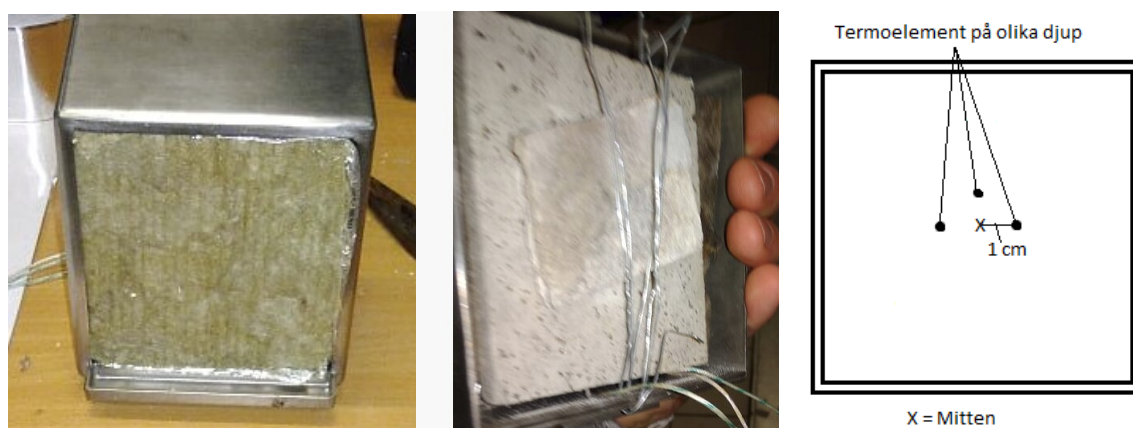
Figur 2. Provbiten placerad i formen och förberedd inför experiment i konkalorimetern, samt schema över termoelementens placering sett framifrån
