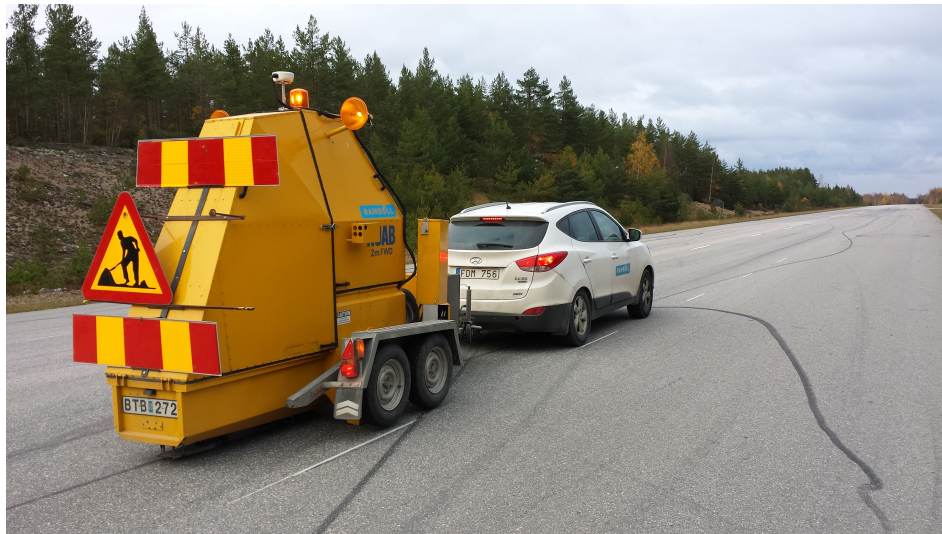
Figur 28 - Bil med tung fallviktsutrustning. Foto: Calle Ossbahr.
