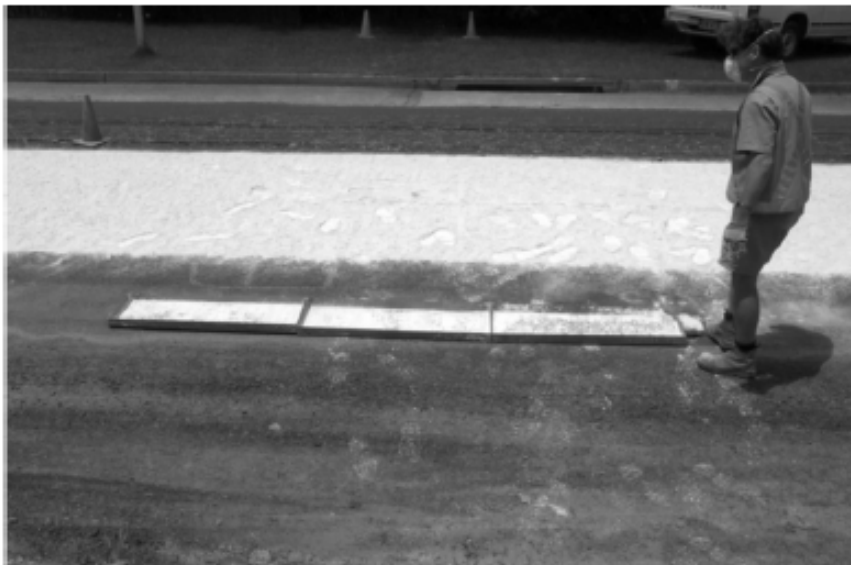
Figur 24 - Kontroll av bindemedelsmängden per ytenhet. Foto: Per Lindh.
