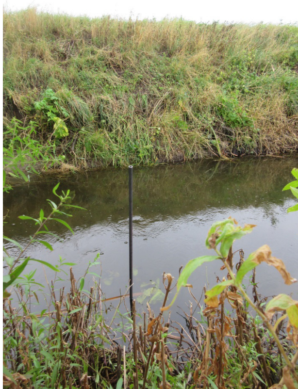
Figur 5-7 Kontrollpunkt 4. Mätningarna av vattennivå i kontrollpunkterna gjordes utifrån kända fixpunkter, i detta fall rörets topp.
