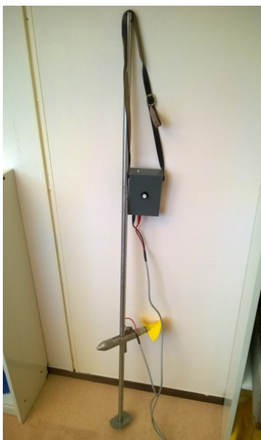
Figur 5-6 Flygelinstrumentet som användes för flödesmätning
