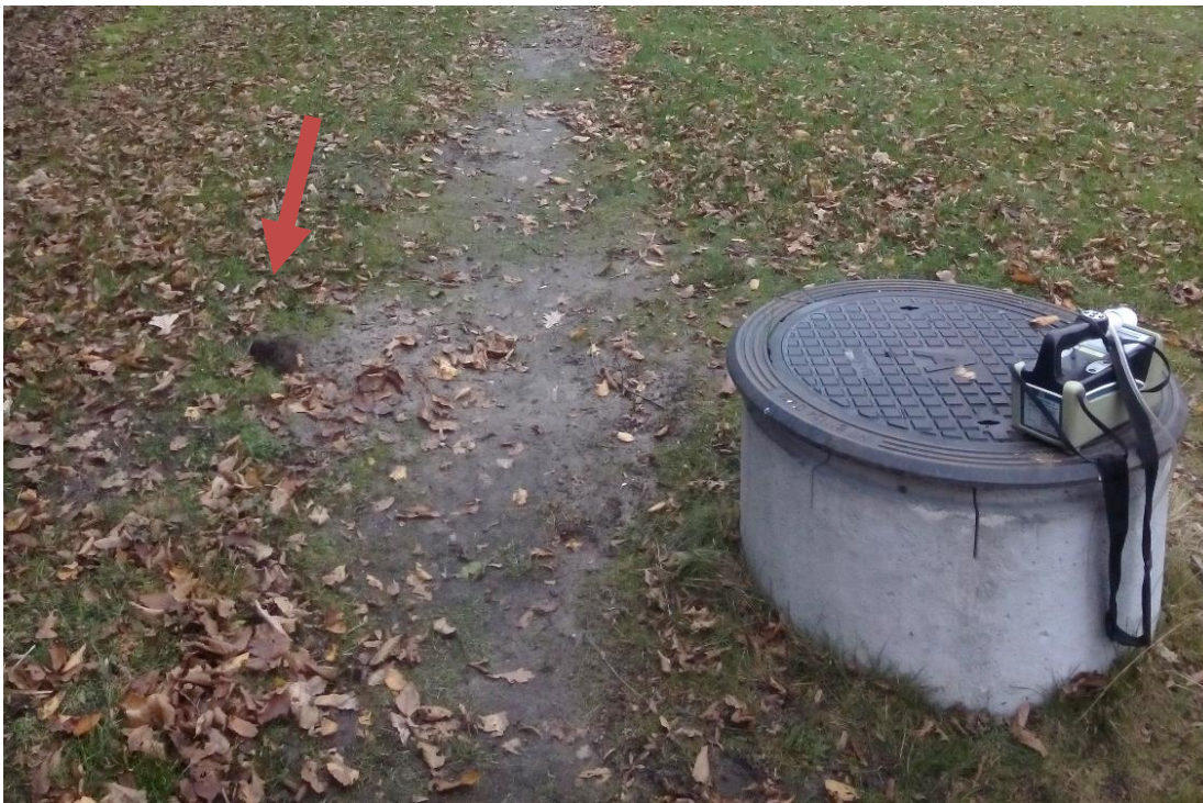
Figur 3.8. Mätplats 5. Gasfiltret på kullen väster om pulkabacken. Pilen visar punkten där metan påvisades på ytan. Foto: Ida Arvidsson.
