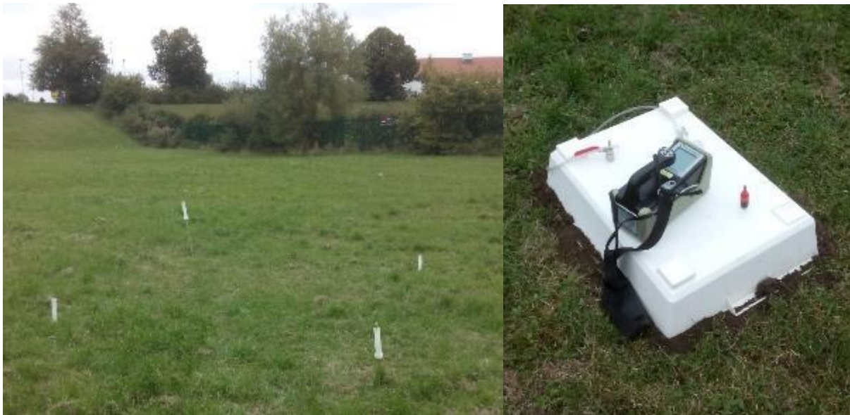
Figur 3.2. Vänster: Vid varje mätplats installerades 1-4 gasspjut. Höger: Mätning med fluxbox. Foto: Ida Arvidsson
