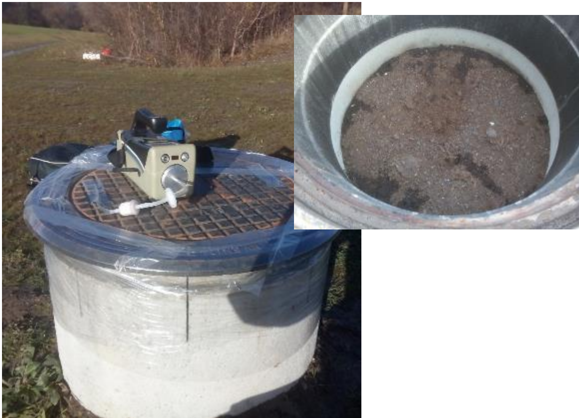
Figur 3.6. Mätplats 2. Bilden till vänster visar mätning över gasfiltret. Bilden till höger visar gasfiltret bestående av torv. Foto: Ida Arvidsson.
