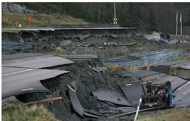
Figur 5.1a. Exempel på brott i jord. (www.e6.se.)
