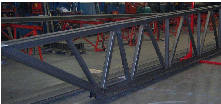
Figur 4.1: Foto på en fackverksbalk i stål
