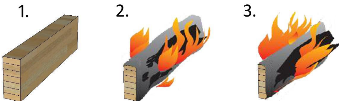
Figur 5.2: 1. Limträ före brand, 2. Limträ efter 30 min, 3. Limträ efter 60 min.
