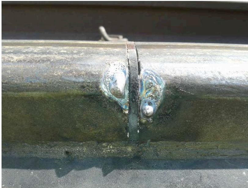
Figur 12: Smält rälsstål (Foto: Nielsen, M. 2012)
