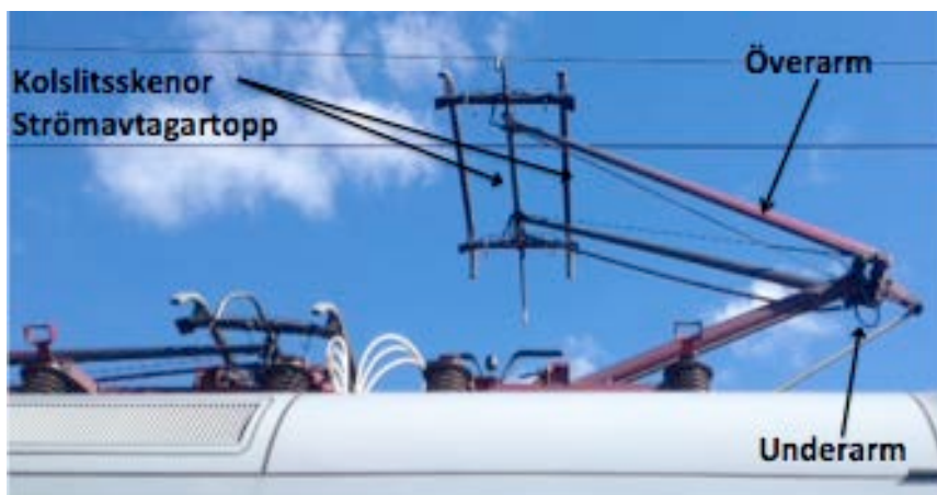
Figur 8: Strömavtagare (DSA 200) på ett Öresundståg (Foto: Nilsson, A.)
