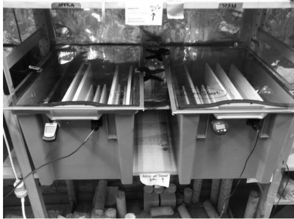
Figur 23. Provkroppar placerade i klimatboxar med saltlösning.
