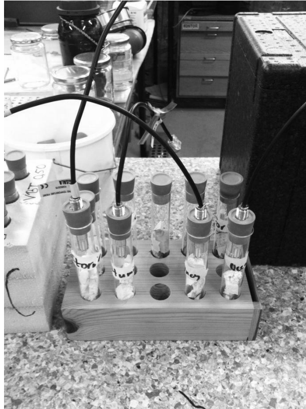
Figur 21. Provrör med RF-givare.
