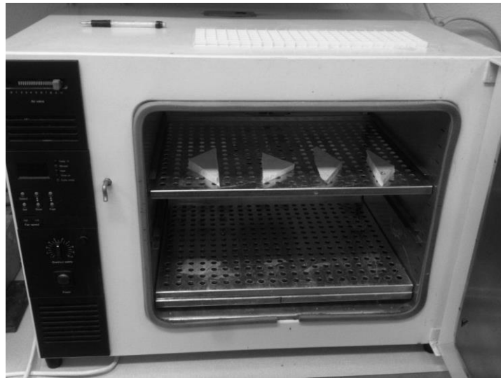
Figur 20. Torkning av lösbrutna provkroppar i ugn.
