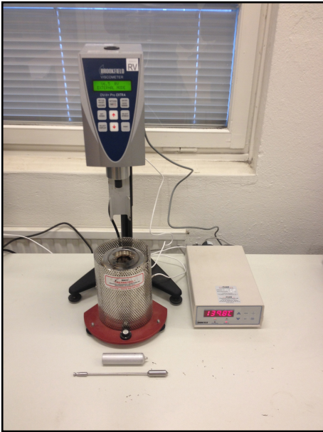
Figur 3-1: Brookfield rotationsviskosimeter med provrör och spindel
