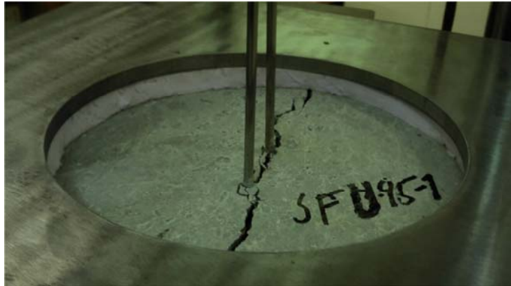
Bild 17. Exempel på böjbrott, testmetod 1.
