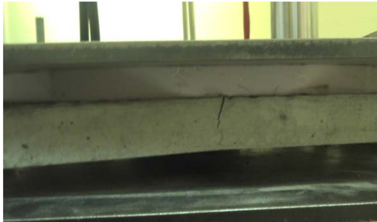
Bild 18. Exempel på böjbrott, testmetod 1.
