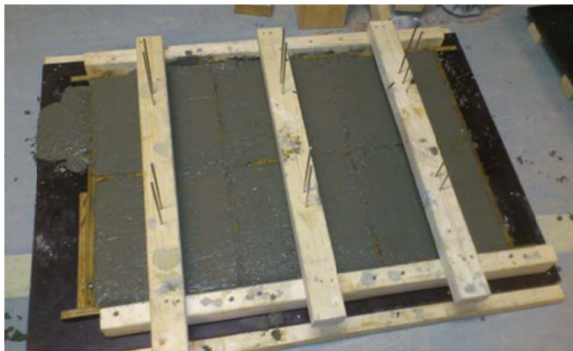
Bild 7. Gjutning av utdragstester med tvärsnittshöjd 30 mm.
