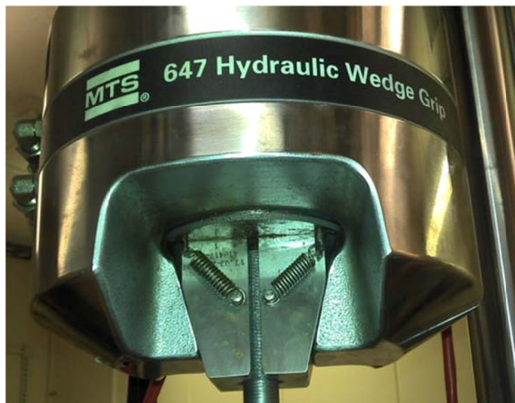
Bild 11. Övre griplon med en inspänd stålstav avsedd att anlägga kraften på balken.
