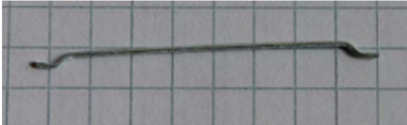
Bild 5. Dramix RC65/40CN placerad på 5 mm rutat papper.
