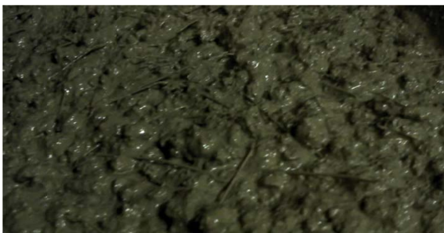
Bild 2. Stålfibrer blandat med färsk betong, dosering: 30 kg/m 3 .
