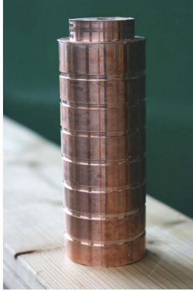
Figur 15 Kopparcylinder som blivit bearbetad inför tester.
