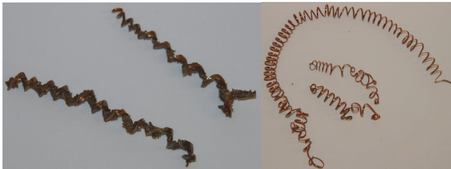
Figur 25 Två exempel på spånor med olika matning. Obehandlat hårdmetallskär (HMO)
