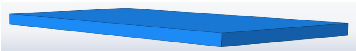
Figur 23 - Geometri som bör förenklas till ett skalelement
