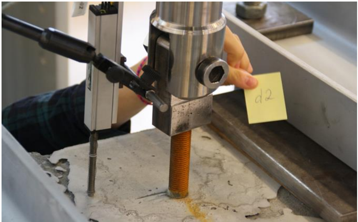
Figur 5.19: Provkropp med avlångt infästningsdon injusterat i lastcell.
