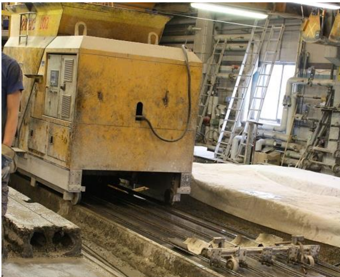
Figur 2.2: Gjutmaskinen placerad på banan med linvagn framför i STARKAs betongelementfabrik i Kristianstad.
