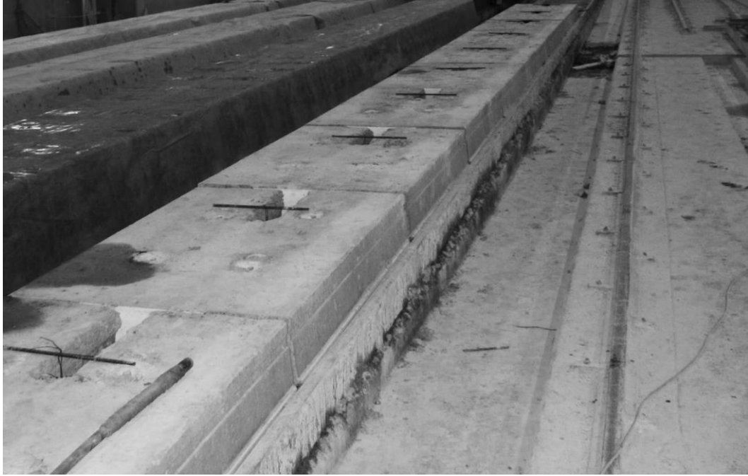
Figur 5.9: Provkroppar uppradade för igjutning.
