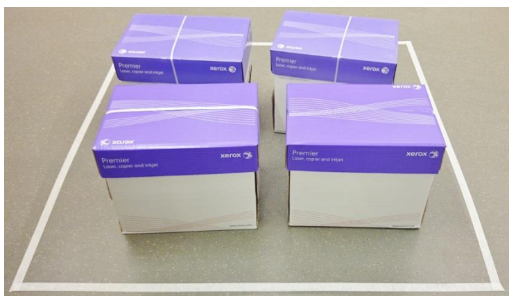
Figur 4. Kartonger med kopieringspapper som ska visa en ungefärlig mängd som innebär att den dimensionerande brandbelastningen för bostäder överskrids. Mängden papper resulterar i en brandbelastning på ungefär 1000 \text{ MJ}/\text{m}^2 .
