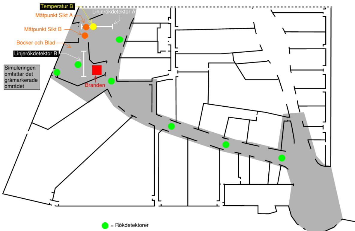
Figur F2. Placering av rökdetektorer samt mätpunkter för sikt och temperatur i simuleringen av Brandscenario A.
