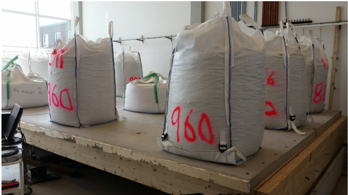
Figur 5.4: Belastning av bjälklagselement, med hjälp av grussäckar.
