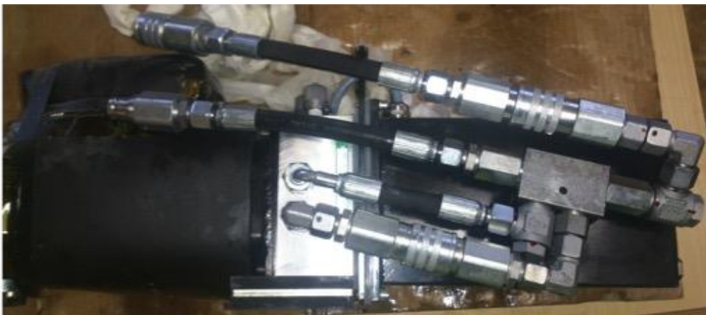
Figur 17 Backgångsspärr version 1. Källa: (Seminarium Krüger, et al., 2015)
