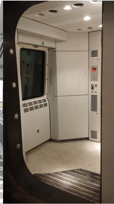
Figur 13 X31, instrumentpanel infäld för multipelkoppling.
