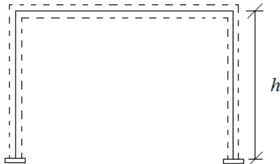
Figur 2.2-5. Definition av konstruktionens systemhöjd, h
