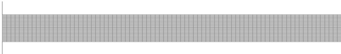
Figur 4.3-5 Inspänningssnitt och elementnät.
