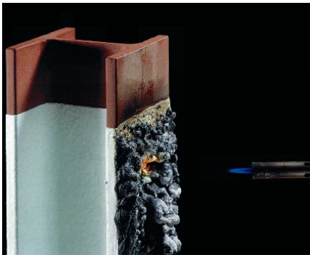
Figur 4.2: Brandskyddsf rg som sv ller upp vid upphettning (Byggbasen, 2010)
