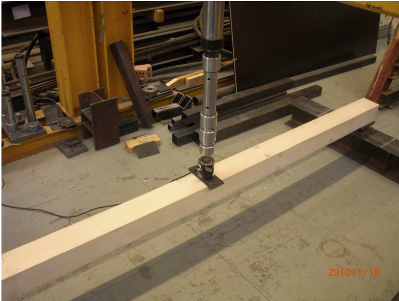
Figur 7.11: Fritt upplagd balk vid deformationstestet
