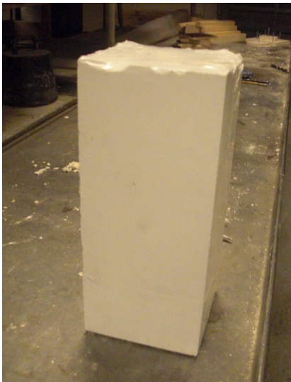
Figur 7.27: Provkropp inlindad i krympplast
