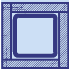
Figur 4.1: 4-sidig montering av Promatect H (Tepro, 1993)
