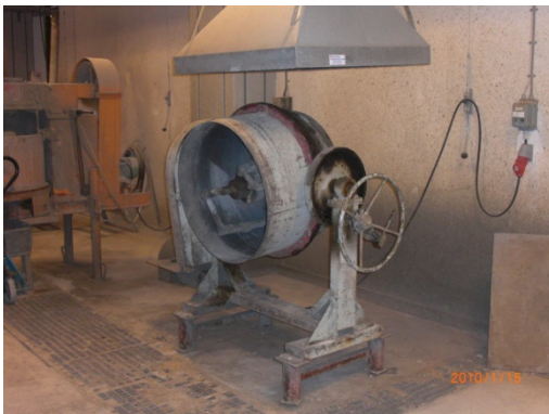
Figur 7.7: Maskin f r blandning av brandgipsmassa
