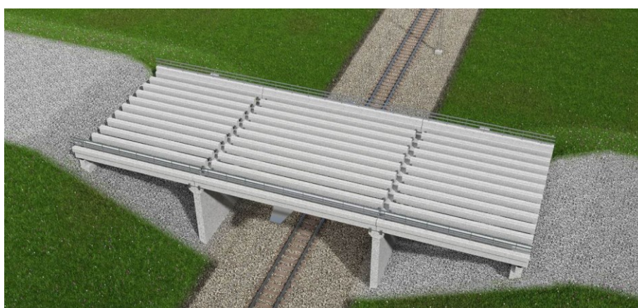
Bild 24 Steg 2, prefabricerade balkarna läggs på plats (NCC (b), 2011).
