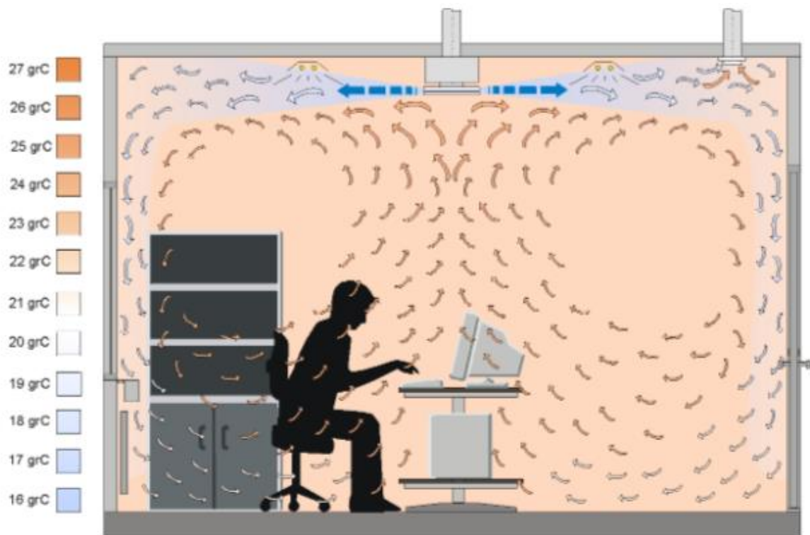
Figur 1. Principen av ett kontor utrustat med omblandande ventilation.
