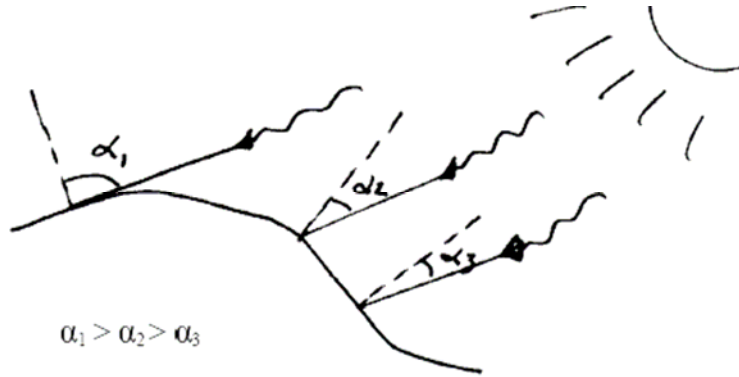
Figur 5. Solzenithvinkeln ( \alpha ), är vinkeln mellan solinstrålningen och normalen för markytan (Falkenström, 1999)
