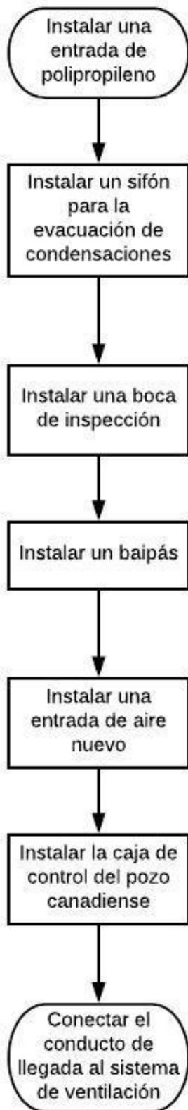
Figura A.0.3. Diagrama de flujo de la instalación interna (**Elaboración propia**)
