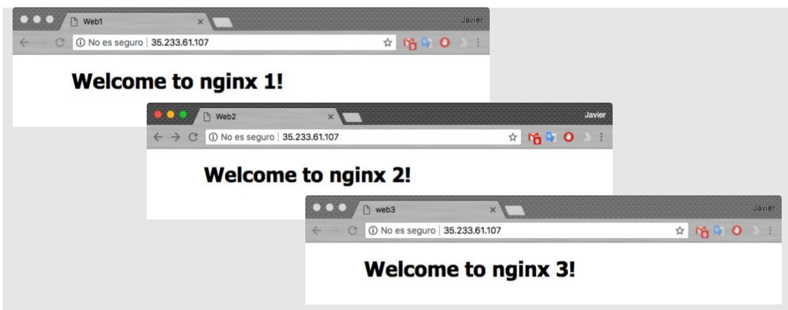
Figura 49. Captura del navegador web de servicio web de tipo LoadBalancer.
