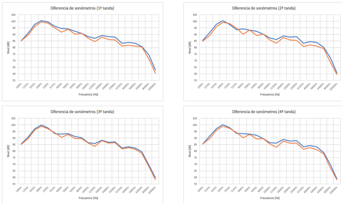
Fig. 7.1. Comparación de los espectros de los dos sonómetros en diferentes momentos de la mañana de medidas. En azul, el sonómetro referencia (99). En naranja, el segundo sonómetro (98).
