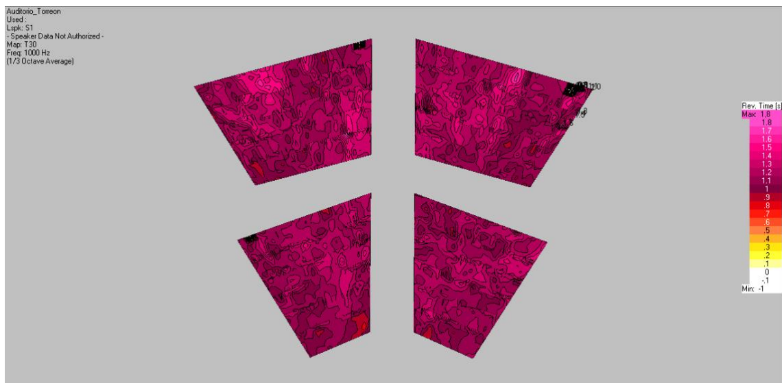
Fig. 9.8. Distribución del parámetro T30 en la frecuencia de 1kHz para el recinto ocupado.
