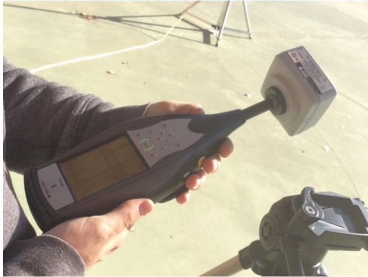
Fig. 6.5. Comprobación de la calibración de un sonómetro.
