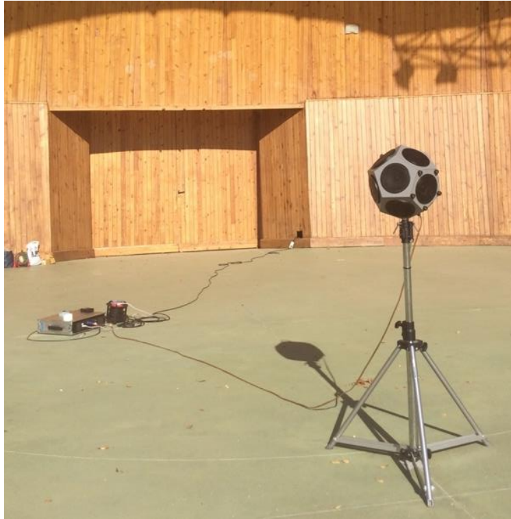
Fig. 6.4. Configuración de los equipos en el escenario.
