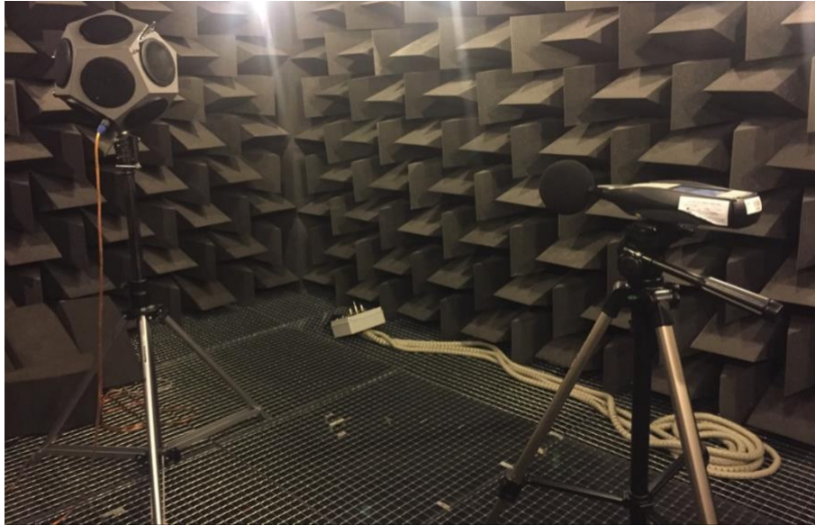
Fig. 6.7. Comprobación del nivel de la fuente dodecaédrica en campo libre.
