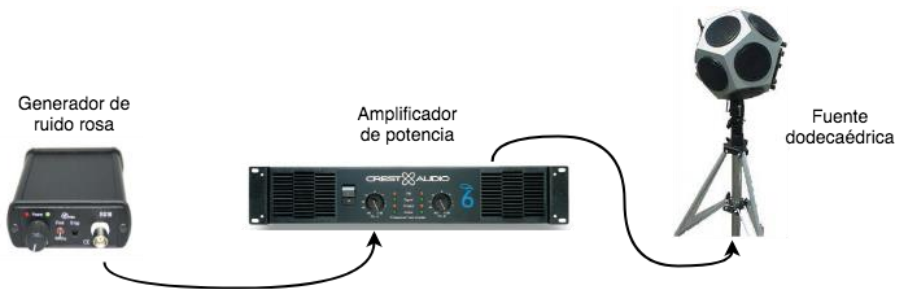
Fig. 6.3. Esquema de las conexiones de los equipos para las medidas in situ.
