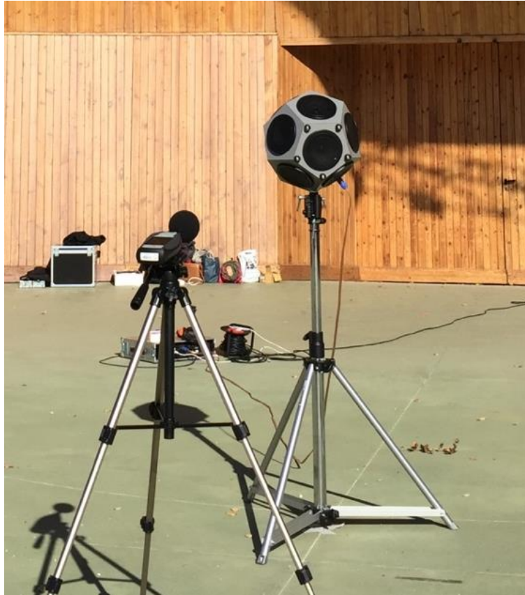
Fig. 6.6. Colocación de los equipos para la comprobación de los sonómetros.
