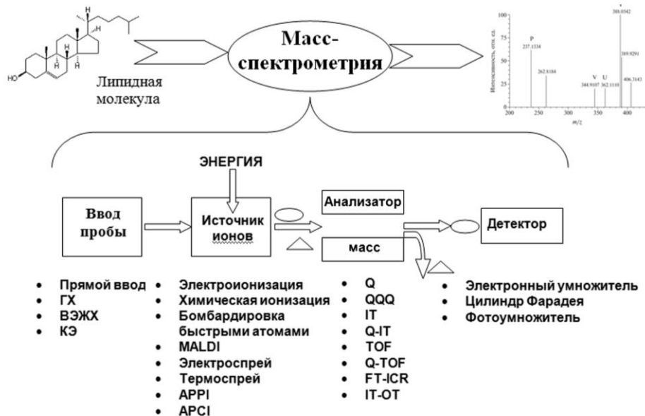
Рис. 7. Схема устройства типичного масс-спектрометра.
