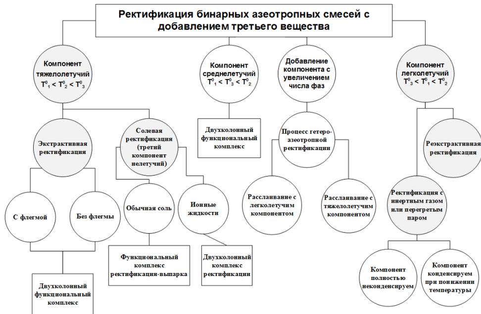
Рис. 1. Виды ректификации в присутствии добавляемого третьего компонента.
