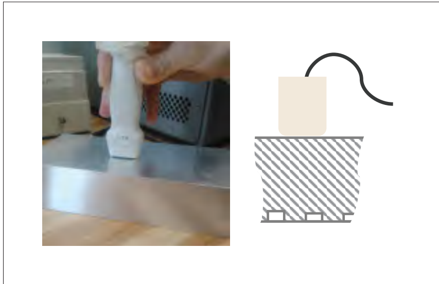
Figure 3.1 À gauche, la sonde multi-élément et le bloc inspecté et à droite, un schéma en coupe du bloc
