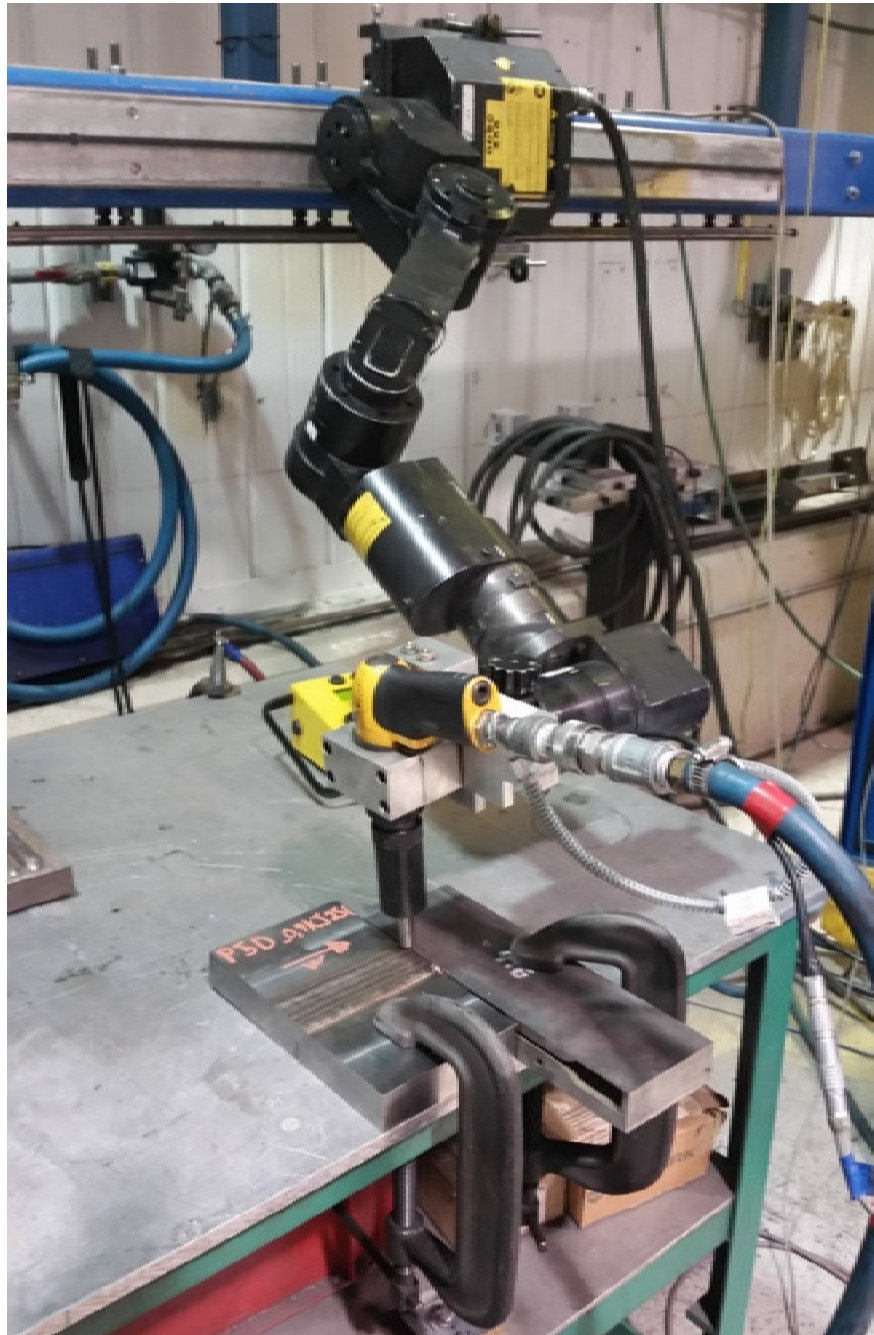
Figure 2.3 Montage pour l'opération de martelage
