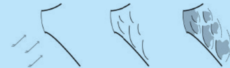
Figuur 6 Ontwerp van de Marker Wadden het invangen van slib de luwten van de eilanden
