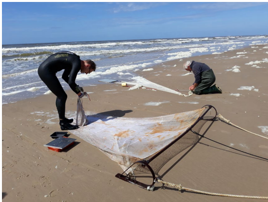
Figuur 3. Voorbeeld van een boomkor (2 m breed, maaswijdte 1 cm gestrekt) welke werd gebruikt bij Castricum aan Zee, met op de achtergrond ook het kornet (1,8 m breed, maaswijdte 2 cm gestrekt).
