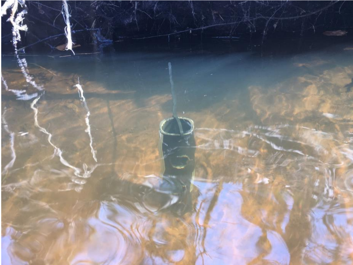
Figuur 3.1: EGV datalogger in PVC pijp op de bodem van de Leuvenumse beek.
