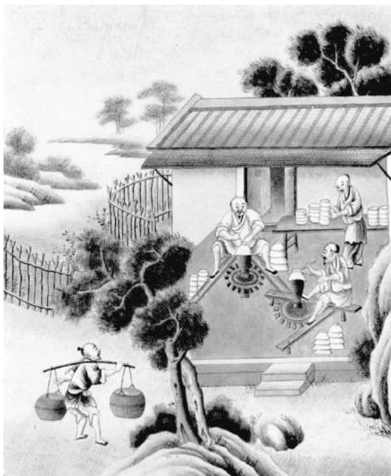
Figure B13 : Tournassage. Illustration : Album anonyme conservé au musée de Rennes, XVIIIe siècle.
