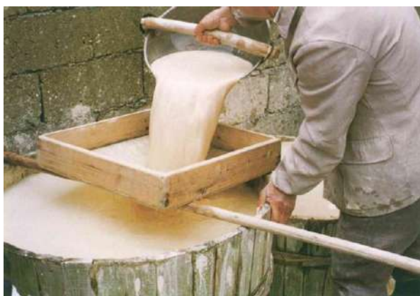
Figure B6 : Tamisage de la barbotine afin de conserver la fraction la plus fine de l'argile, Jingdezhen. Photographie : M. Bai (Bai 2005)
