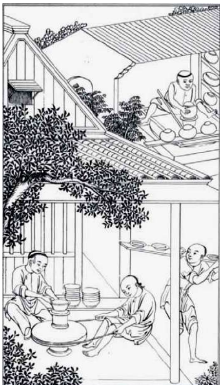
Figure B11 : Le moulage des pièces (en haut à droite). Illustration : Jingdezhen taolu tushuo (Recueil illustré de la céramique de Jingdezhen) 1815).
