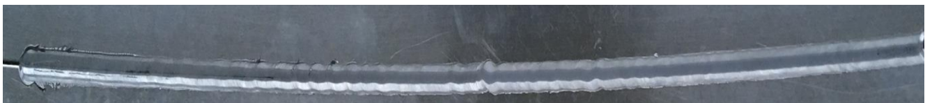
Figure 4.25 – Essai PC : cordon de soudure
