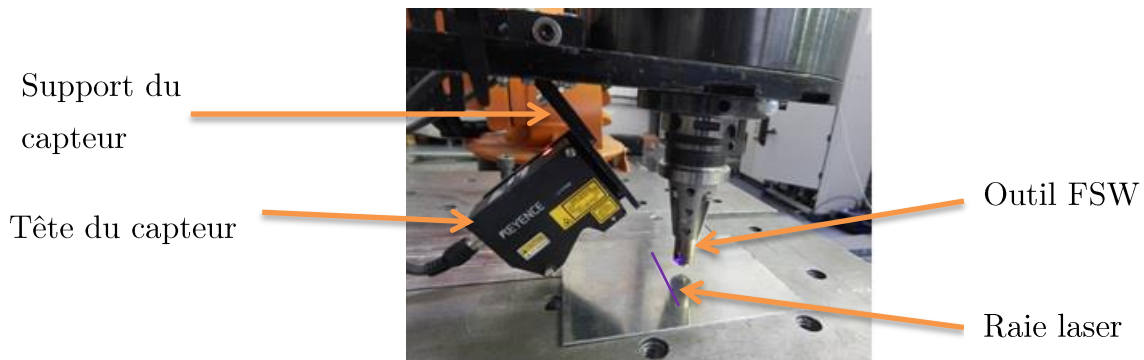
Figure 4.1 – Montage du capteur sur le robot
