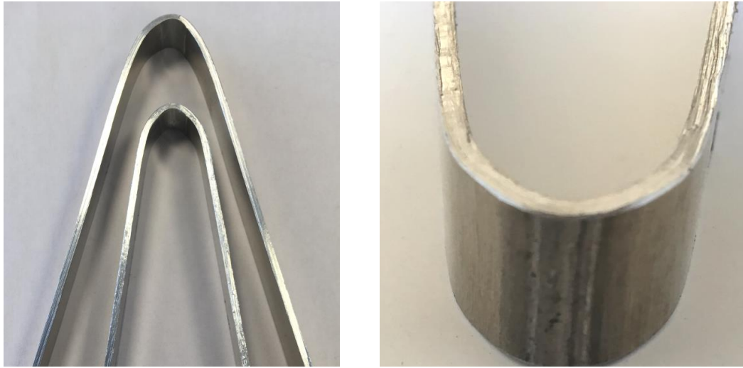
Figure 4.21 – Essai AP : pliage à l'envers sur coupons
