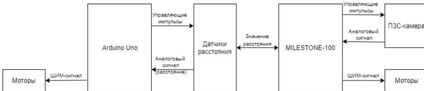
Рис.1. Структурная схема прототипа
