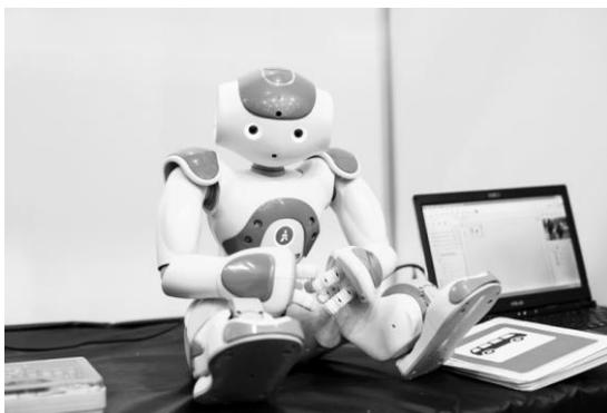
Рис. 1. Автономный робот NAO
