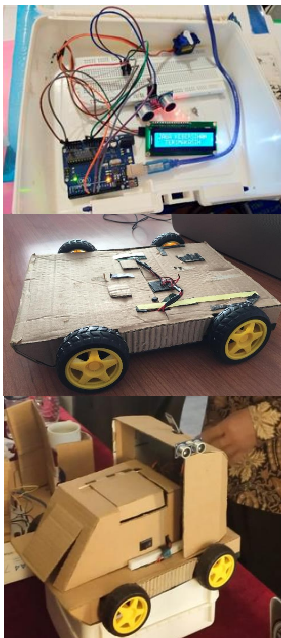
Gambar 18. Purwarupa Sederhana Tong Sampah Pintar Dengan Perintah Suara
