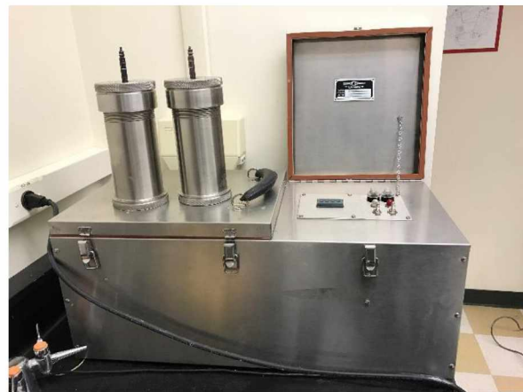
(d) OFITE Portable Roller Oven and Aging Cells
