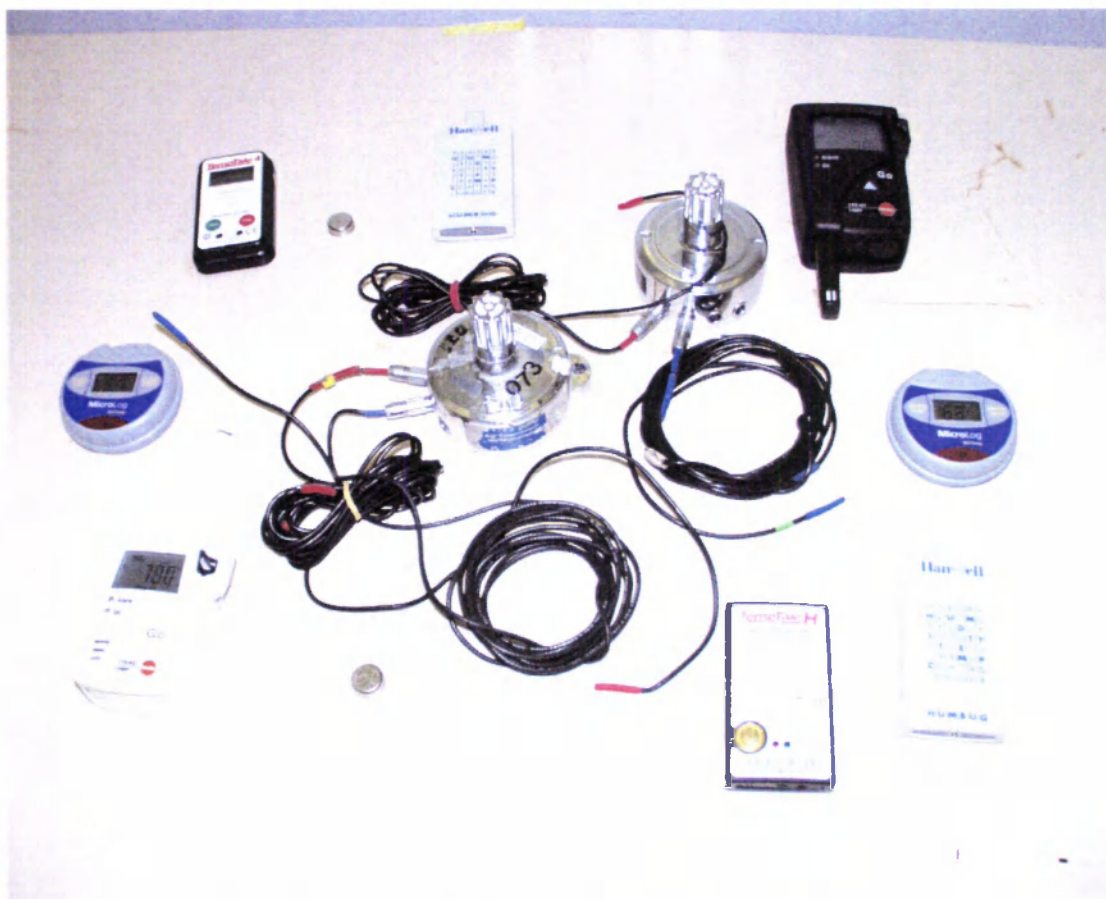
Figuur 3 – overzicht van de geteste data-loggers in de geconditioneerde cel.
