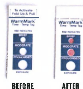
Figuur 5 – “WarmMark” van IntroTech
