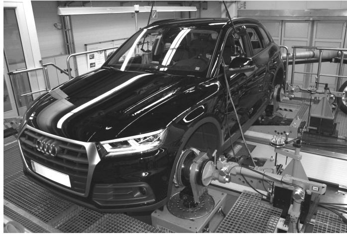
Abbildung 3.4.: Statischer K&C-Prüfstand mit aufgespanntem Fahrzeug zur Identifikation der Achskinematik und der Achselastokinematik.
